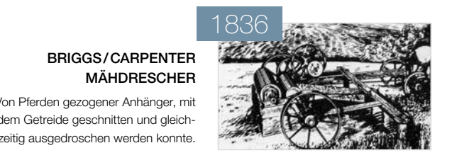
BRIGGS/CARPENTER MÄHDRESCHER Von Pferden gezogener Anhänger, mit dem Getreide geschnitten und gleichzeitig ausgedroschen werden konnte.
