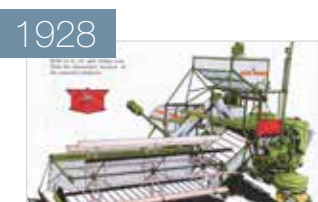
JOHN DEERE NO. 1 Vom Traktor gezogene Maschine. Zum Antrieb des Mähwerks diente ein separater Aufbauantrieb.
