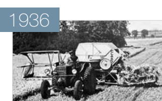
CLAAS MDB (= MÄH-DRESCH-BINDER) Erster praktischer Mähdrescher Deutschlands. Arbeitete nach dem Querflüßprinzip. Als Antrieb wurde ein mindestens 35 PS starker Traktor benötigt.
