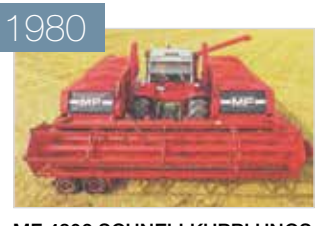
MF 402 SCHNELLKUPPLUNGS MÄHDRESCHER Ein Schneid- und zwei selbst angeordnete Dreschwerke gruppieren sich um einen leistungsstarken Traktor mit Rückfahrwinde.
