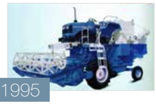
SONALIKA In Indien hergestellter Mähdrescher, der von einem aufgestauten, räderlosen Traktor angetrieben wird.
