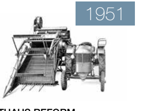
CLAAS ZAPFWELLEN MÄHDRESCHER, SYSTEM BRENNER Angeboten von einem Bulldog, entwickelte Gustav Brenner einen Prototypen mit Vorderschnitt. Einstieg von CLAAS in die Mähdrescher-Entwicklung.
