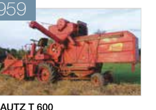
BAUTZ T 600 Unverwundlicher Bauernmähdrescher mit langer Lebensdauer. Beachtliche Leistung, gute Reinigung und geringe Körnerverluste begründeten seine große Popularität.
