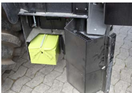
Hinter der Verkleidung gibt es Platz für eine richtige Werkzeugkiste. Oben findet man die Sicherungen.
