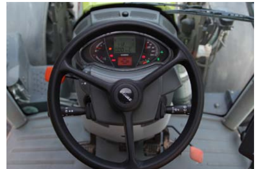
Der neue Armaturenräger ist jetzt samt Lenkrad schwenkbar.
